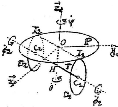
Le plateau, la tige et les deux disques sont des solides homogènes. On note  $\dot{\psi}$  et  $\dot{\theta}$  les vitesses de rotations du plateau ( $P$ ) et de la tige ( $T$ ) respectivement par rapport au référentiel du laboratoire  $R_0(x_0, y_0, z_0)$  et on désigne par  $\dot{\phi}_1$  et  $\dot{\phi}_2$  les vitesses de rotations de  $D_1$  et  $D_2$  par rapport à la tige ( $T$ ).
