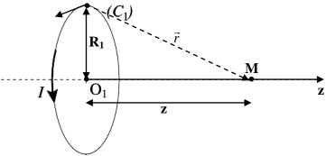
**4.2.2-** A l'aide de la loi de Biot et Savart. Déterminer le champ  $\vec{B}(M)$  en un point M(0,0,z) de l'axe  $(O_1z)$ , montrer qu'il peut s'écrire sous la forme :  $\vec{B}(M) = I.f(z)\vec{u}$ .
