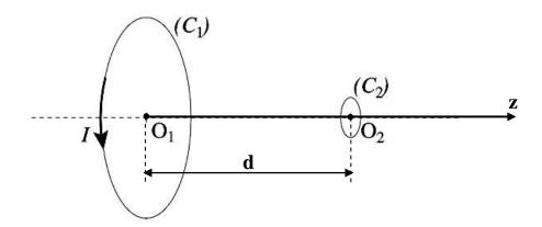
**4.2.3-** Dans cette question les spires ( $C_1$ ) et ( $C_2$ ) sont fixes et distantes de  $d = O_1O_2$ . Le courant dans ( $C_1$ ) est constant ( $I = I_0$ ).
