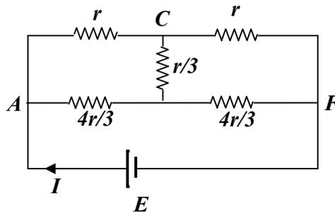
On doit maintenant appliquer la transformation de Kenelly soit du côté  $AC$  soit du côté  $CF$  et on fait la somme des résistances qui sont en série :
