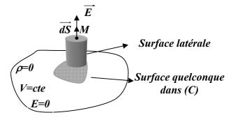
Au voisinage de la surface d'un conducteur à l'équilibre électrostatique prés d'un point où la densité de charge est  $\sigma$ , le champ est normal à la surface du conducteur et il est égal à  $\sigma/\epsilon_0$ .
