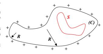
On dépose une charge Q en un point de ce conducteur. A l'équilibre toutes les charges sont immobiles :  $\sum \vec{F} = \vec{0} = q\vec{E} \implies \vec{E} = \vec{0} = -\overrightarrow{gradV} \implies V = cte$ .
